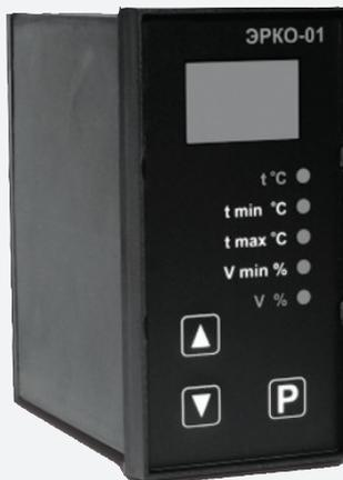
Блоки управления вентилятором для систем кондиционирования воздуха ЭРКО-01 и ЭРКО-02 предназначены для регулировки скорости вращения вентилятора в зависимости от температуры, измеряемой внешним датчиком. Приборы применяются для поддержания необходимого давления в кондиционерах, что позволяет им работать в режиме охлаждения при температуре наружного воздуха до  $-25^{\circ}\text{C}$  (см. стр. 31).
