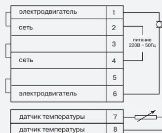
Контакты 1-2, 3-4, 5-6 соединены попарно. Для включения электродвигателя на максимальную мощность поставить перемычку между контактами 3 и 5. Датчик температуры не имеет полярности.
