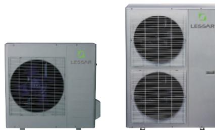
**LMV-Heat Recover** – наружные трехтрубные блоки производительностью 25.2 и 28 кВт, внутренние блоки которых могут одновременно и независимо друг от друга работать в режиме охлаждения и обогрева.
