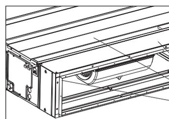
Корпус для фильтра РАС-КЕ91~95 ТВ-Е позволяет подключить воздуховод к входу внутреннего блока и извлекать фильтр для обслуживания снизу или сбоку
