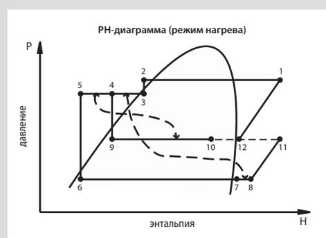
Часть жидкого хладагента, ответвленная от основного потока в цепь инъекции, превращается в парожидкостную смесь среднего давления. При этом температура смеси понижается, и она подается через специальный штуцер инъекции в компрессор, осуществляя полное промежуточное охлаждение хладагента в процессе сжатия и обеспечивая тем самым расчетную долговечность компрессора.
