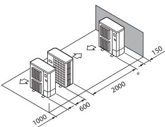
Параллельное расположение 2-х блоков
