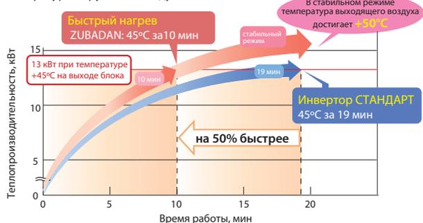
Температура наружного воздуха  $-20^{\circ}\text{C}$
