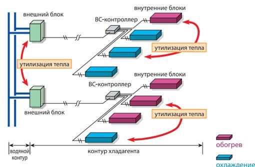
Системы серии WR2 имеют два дополнительных преимущества относительно серии WY. Первое – это полная независимость пользователей и возможность одновременной работы внутренних блоков в режимах охлаждения и обогрева. Второе – максимальная эффективность за счет двух контуров утилизации тепла: контура хладагента в рамках каждой системы и контура теплоносителя, объединяющего несколько систем.
