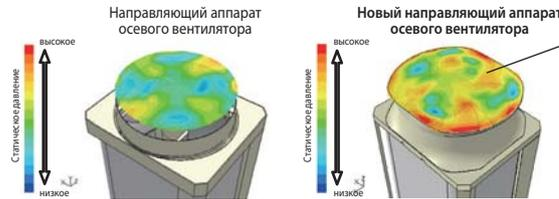
Новый выходной направляющий аппарат осевого вентилятора наружного блока позволяет достичь повышенного статического давления при меньшей частоте вращения вентилятора и пониженном электропотреблении.
