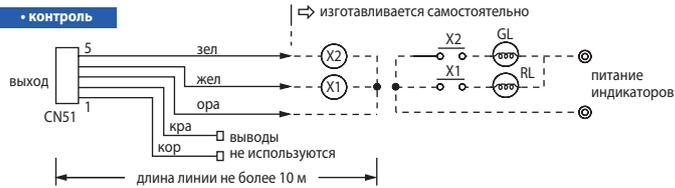
X1 - состояние: включен/выключен
