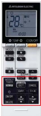
Таймер позволяет задавать до 4 действий<sup>1</sup> в течение дня: включение/выключение и изменение целевой температуры.
