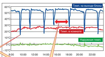
Благодаря специальным алгоритмам управления интервал между режимами оттаивания увеличен до 150 мин (при температуре наружного воздуха в диапазоне от  $-20^{\circ}\text{C}$  до  $0^{\circ}\text{C}$ )
