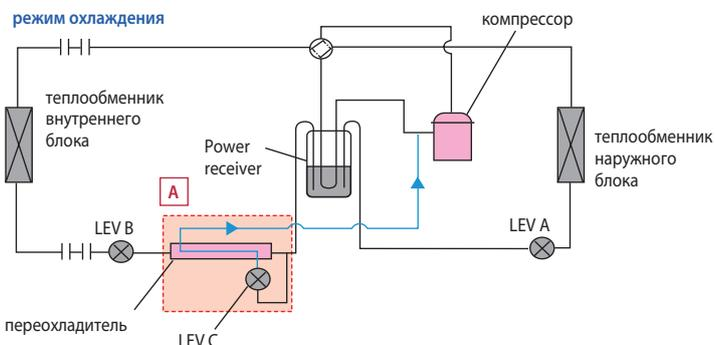
Переохладитель добавлен в гидравлический контур для увеличения энергоэффективности системы в режиме охлаждения. Часть жидкого хладагента испаряется в переохладителе и поступает на вход компрессора, увеличивая давление в линии всасывания. Нагрузка компрессора уменьшается, а энергоэффективность системы увеличивается.
