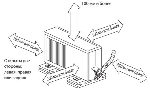
Если блок устанавливается на раме, то ее высота должна в 2 раза превышать максимальную высоту снежного покрова.
