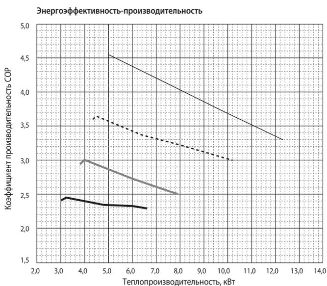
■ Температура воды на выходе +55°C
