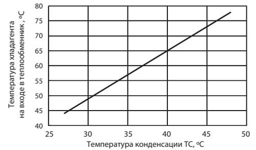
Рис. 2. Температура хладагента на входе в теплообменник
