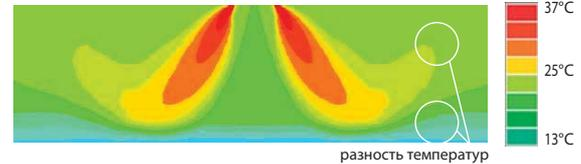
Включен датчик "I SEE", а также автоматическое изменение скорости вентилятора. Целевая температура — 20°C.
