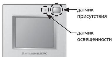
Режим сниженного электропотребления будет активирован, если датчик присутствия фиксирует, что в помещении нет людей (отсутствует движение в течение некоторого времени).
