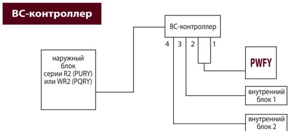
Существуют модификации BC-контроллеров с разным количеством портов (штуцеров для подключения внутренних блоков). Выбор модификации осуществляется, исходя из количества помещений, в которых нужно обеспечивать охлаждение и обогрев независимо. Также следует принимать во внимание суммарную производительность внутренних блоков.
