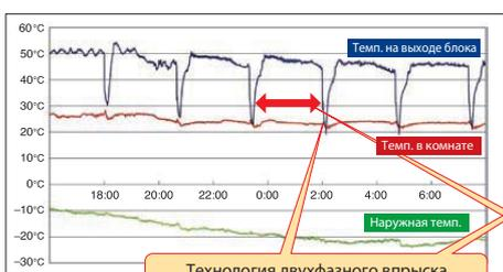
Технология двухфазного впрыска сокращает длительность режима оттаивания с 4 до 3 мин.
