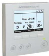
Полнофункциональный проводной пульт управления PAR-31MAA оснащен большим жидкокристаллическим экраном с подсветкой. Интерфейс пользователя русифицирован.
