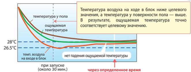
Система учитывает температуру воздуха у пола, поэтому ощущаемая температура стабильно держится на уровне 28°C. Кроме того для создания такого эффекта мощность охлаждения уменьшается через определенное время. Это приводит к существенной экономии электроэнергии.
