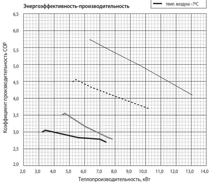
■ Температура воды на выходе +45°C
