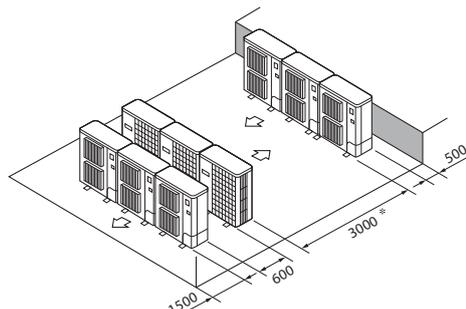
Параллельное расположение нескольких блоков
