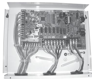
Контроллер РАС-IF012В-Е предназначен для плавного (ступенчатого) управления наружными блоками полупромышленной серии Mr. Slim: ZUBADAN Inverter: PУНН-ZRP35~140; Deluxe Power Inverter: PУНН-RP200/250YKA; Power Inverter: PУНН-RP200/250YKA; Standard Inverter: SUZ-KA, PУНН-P100~140VHA/YHA и PУНН-P200/250YHA.
