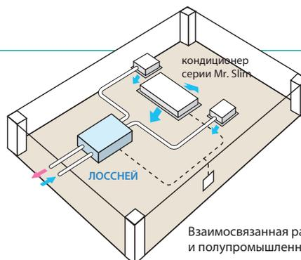
Взаимосвязанная работа вентустановки ЛОССНЕЙ и полупромышленного кондиционера
