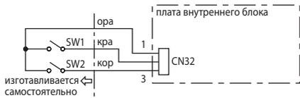
SW1: включить/выключить (действует только при замкнутом SW2)
