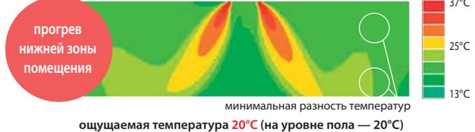
Датчик "I SEE" определяет недостаточно нагретую зону помещения. Система управления внутреннего блока дает команду увеличить скорость вентилятора. В результате, мощный поток теплого воздуха греет воздух около пола.
